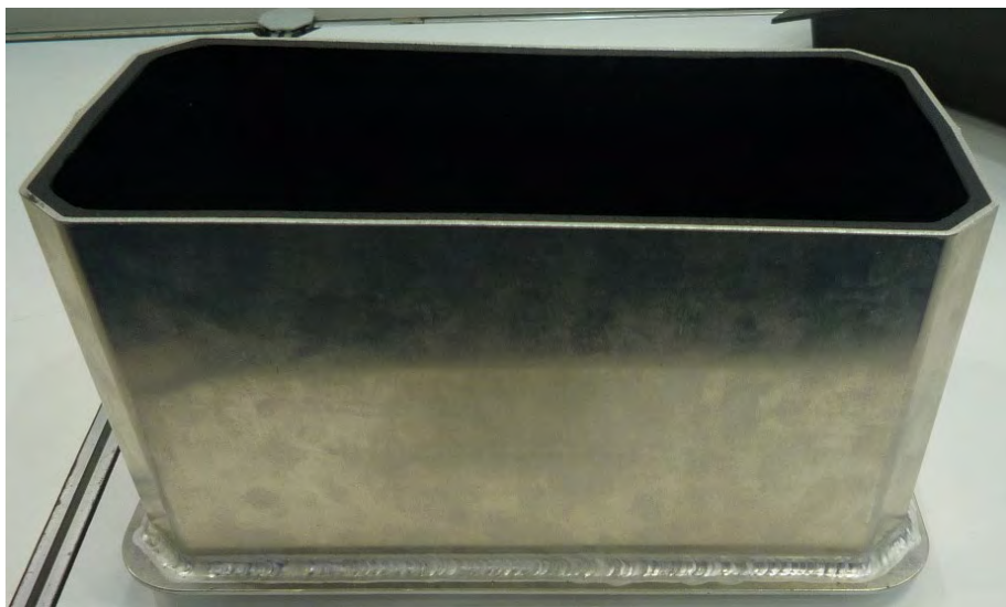
回転成形を応用した、金属製タンクへの耐蝕性付加技術
