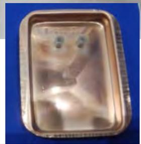
導電ペースト回路形成PBTフィルム一体成形
