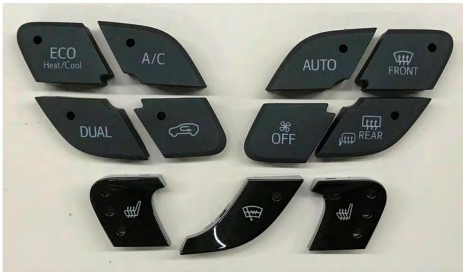
レーザーによる塗膜部分剥離
