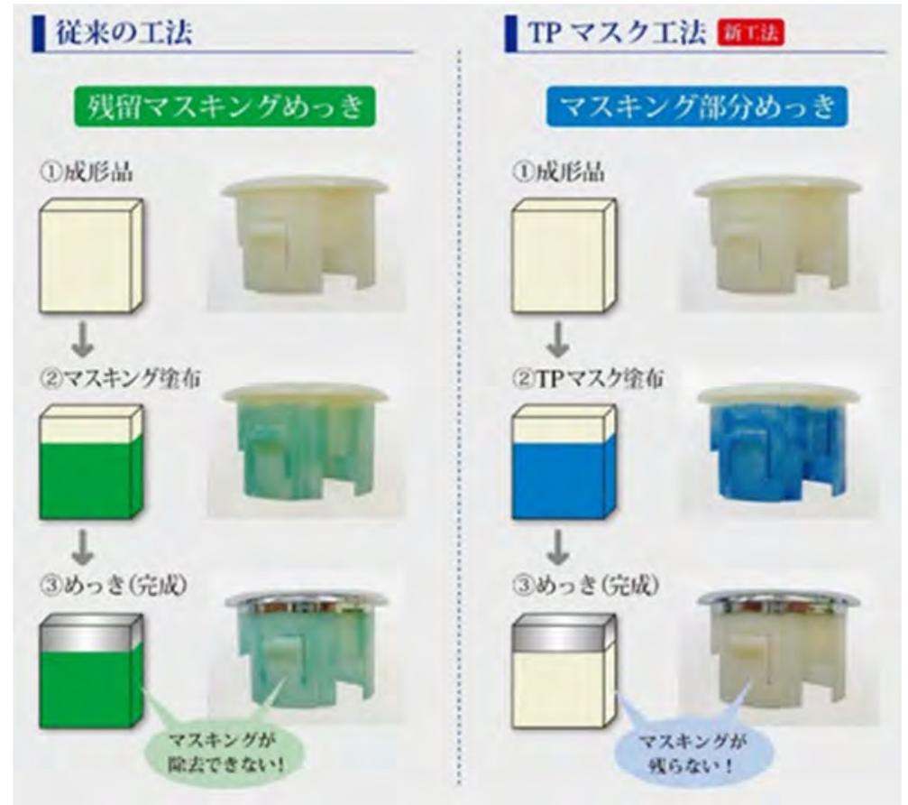
2色成形品へのめっきでも部分めっき可能であるが、TPマスク法では、マスクングが残らず、一体成型が可能
