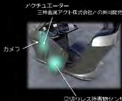
ドアパネル内部に搭載した障害物検知センサーが、超音波信号を生成ドアパネル外部へ放射。障害物から反射波が到達するまでの時間計測により、障害物との距離をセンシング
