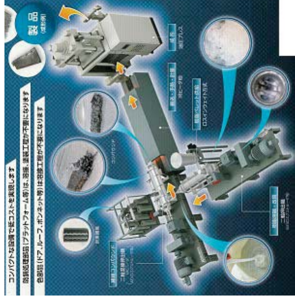
図16 栗本鉄工所のCarbon-LFTD製造設備
