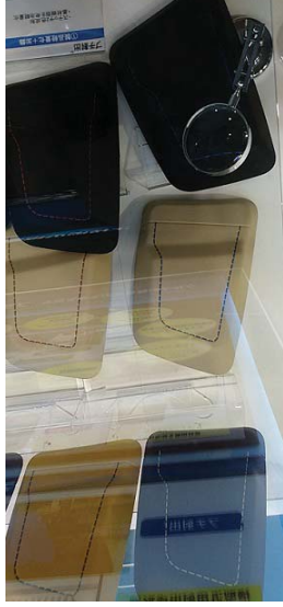
図10 宇部興産機械のプチ成形によるステッチ成形
