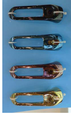
図12 塚田理研のメッキー2(イオンプレATING併用) メッキ上にチタン系材料をイオンプレATINGすることで、高機能のカラーメタリック品 が得られる(イオンプレATING条件によって色を変更できる)
