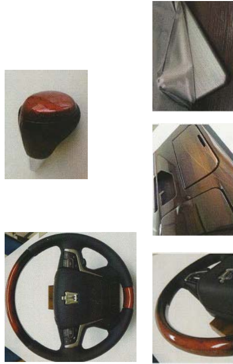
図4 フジコーの3Dドライ転写加飾
