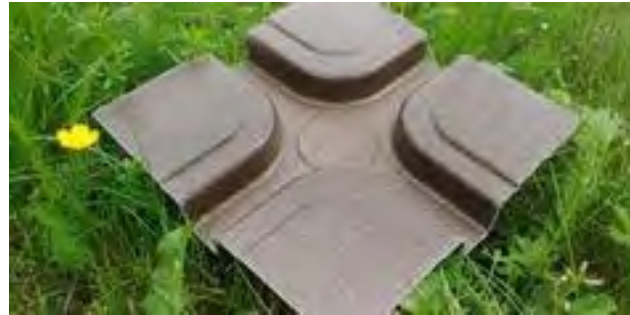
ポリ乳酸と亜麻織物の組み合わせたTepex
