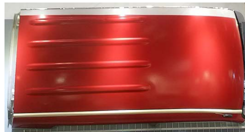
単に塗装代替ではなく、フィルムOMDの特徴を生かした機能性付与外板を目指している
