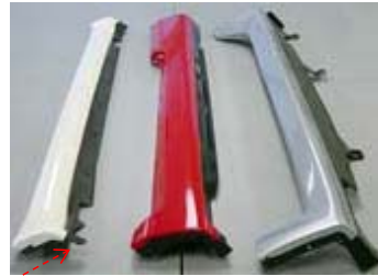
rocker panels : Soliantの Fluorex dry paint filmでバックモールド
