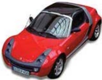
Smart carの roof module: GEの Lexan SLX filmに LGFPUをバックモールド
