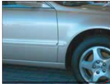
Acuraのrocker panels と body side : Soliantの Fluorex dry paint filmでバックモールド
