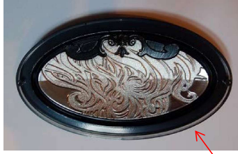
OMDによる文字 合せ成形品 (浅野研究所)*
