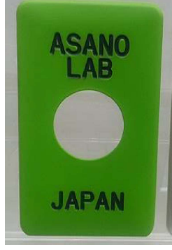
OMDによる文字 合せ成形品 (浅野研究所)*
