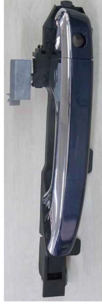
ホンダロックのスマートエントリーシステム用ドアハンドル
