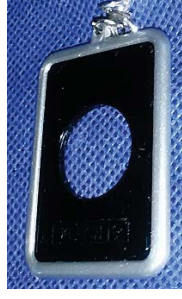
ABSピアノブラックはH&C。ABSは特殊成形技術の適用が困難で、H&Cなしで、完全にウエルドレスが消えない。引き継ぎ検討中。
