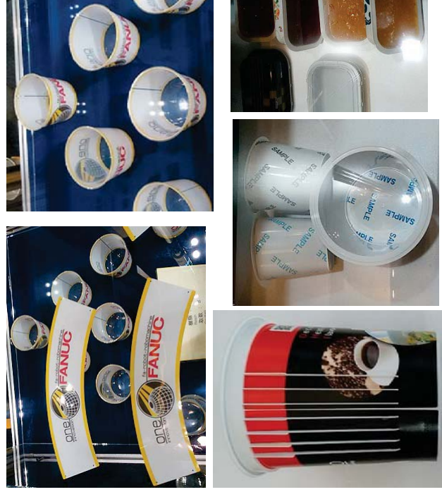
ファンックのIM-L。 多数個取り、数秒サイズ クルで全自動成形
