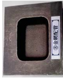
MTM工法に用いる電鍍金型。キャビティに沿って、キャビティ直下に配管。温調効率が高い
