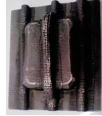
MTM工法に用いる電鍍金型。キャビティに沿って、キャビティ直下に配管。温調効率が高い
