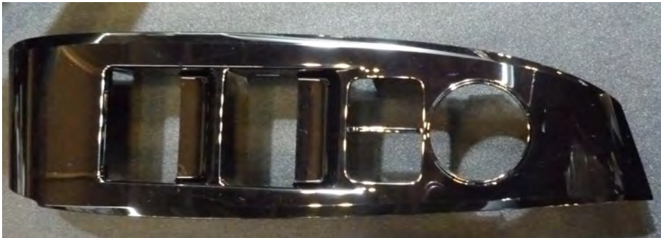
H&C成形 (ABSピアノブラック) ABS(非晶性)では、高温が必要で、 H&Cが必要
