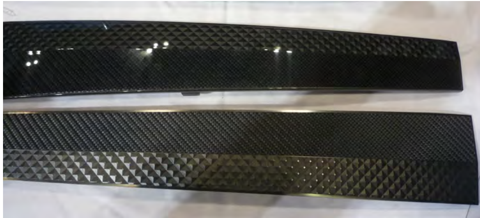
UBEマシナリのPP/GFPPの2層成形+塗装
