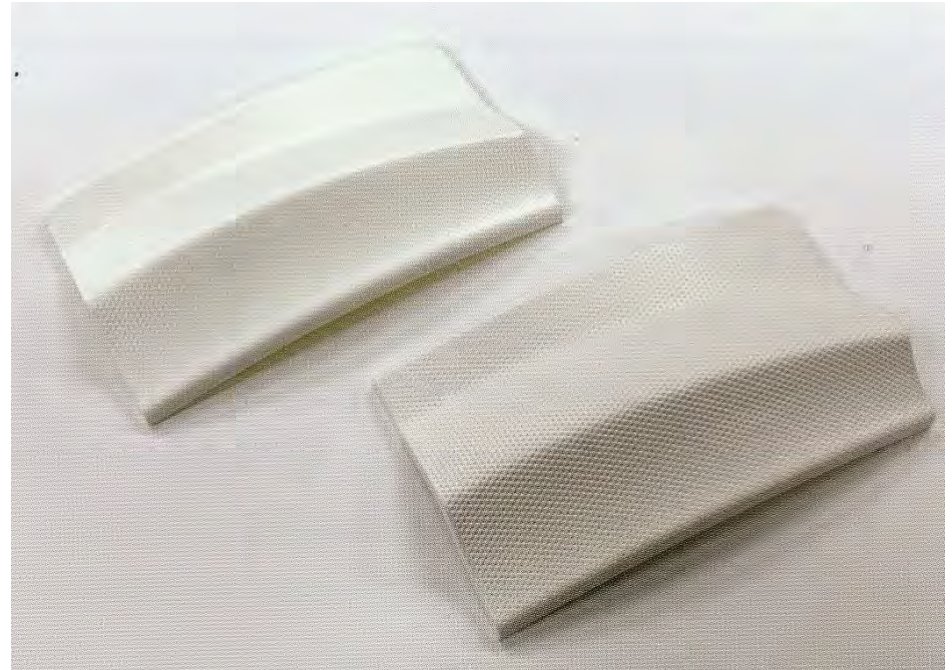
左: 3Dプリントによる造形品 右: 最終成形品
