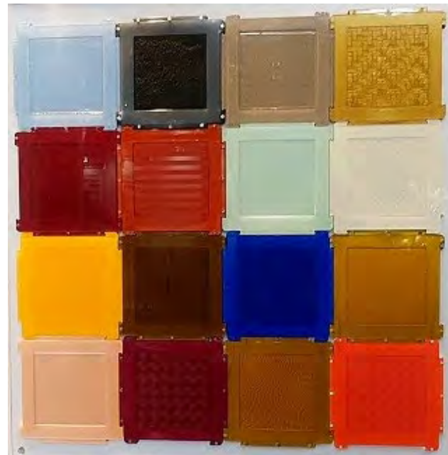
フィルムインサート 加飾(クリア層の裏に様々なシボ→ テクスチャを際立たせる)
