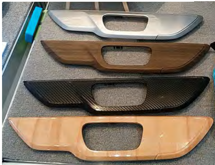
KALM工法(成形品に後からフィルムを貼合、転写=OMD)
