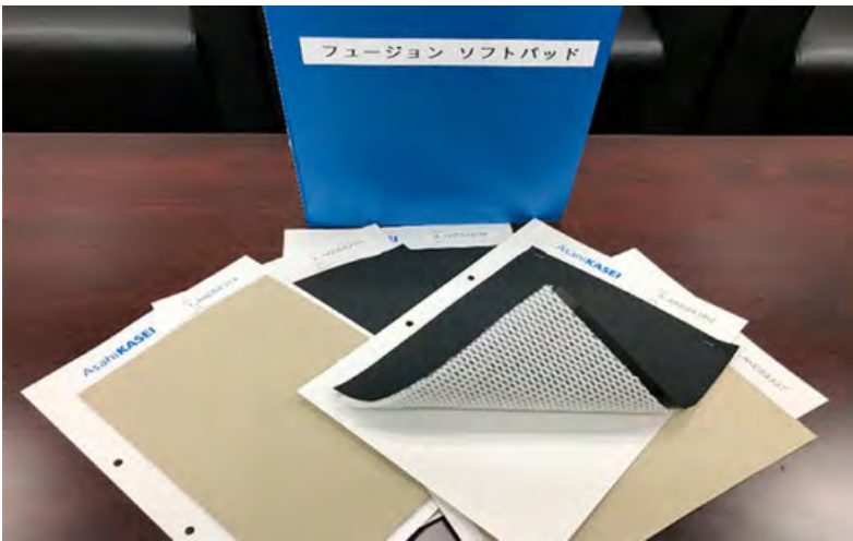
立体編物フュージョン+合皮・PVC 反応性ホットメルト貼り合せ
