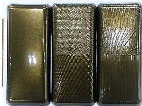
D3テクスチャ金型を用い、ピュアサーモシートをIMF
