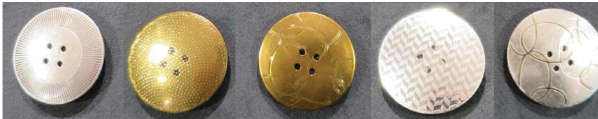
金属上へのテクスチャ転写見本(金属ボタンは共通)
