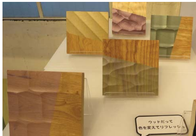
ウッドテクスチャ板への貼合せ例
