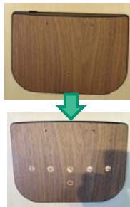
静電タッチセンサ組合せ例
