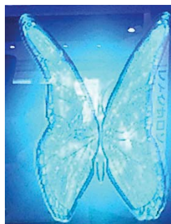
ハーフミラー組合せで、バックライトで隠れた模様表示
