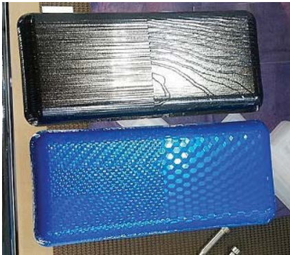
D3テクスチャ金型 使用によるIM-D成形品
