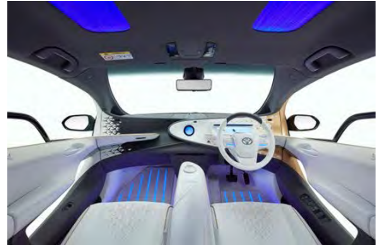
トヨタ自動車の電気自動車コンセプトカー「LQ」のドアトリム（ケナフ繊維強化PU）
