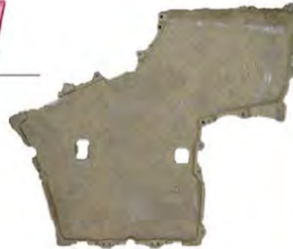
ケナフ発泡ボード Kenaf form base material
