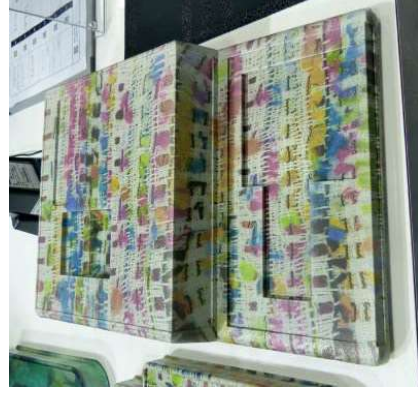
図33 インクジェット製膜例ー2 インクジェットフィルム、シートからの成形品例
