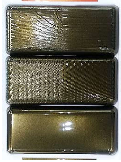
D3テクスチャ金型(KSDL)を用い、ピュアサーモシート(出光)をIMF
