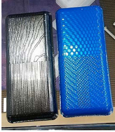
D3テクスチャ金型(KSDL)を用い、ピュアサーモシート(出光)をIMF
