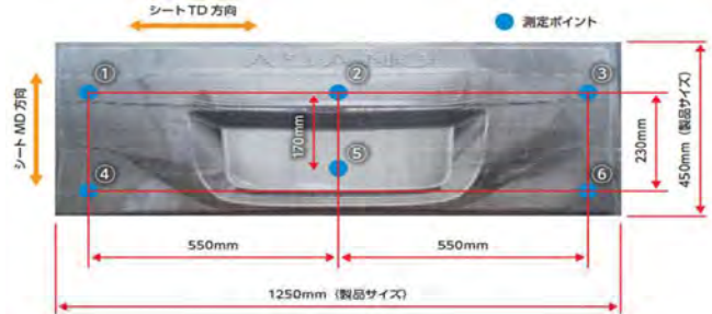
バックドア試作品 (位置精度±0.5mm)
