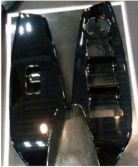
図10-1 旭電器のピアノブラック成形品-1
