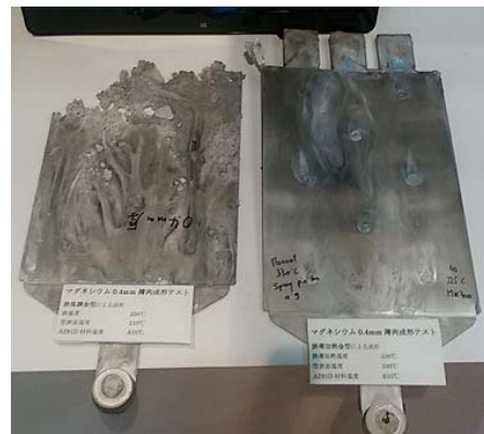
Mg合金射出成形の成形(右がRockTool)
