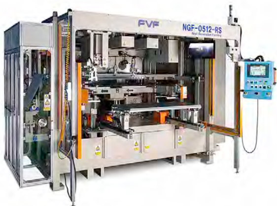
3次元レーザトリミングマシン
