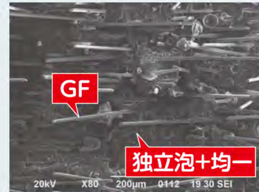
PP-LGF+発泡MB射出試験片破断面 (SEM画像)
