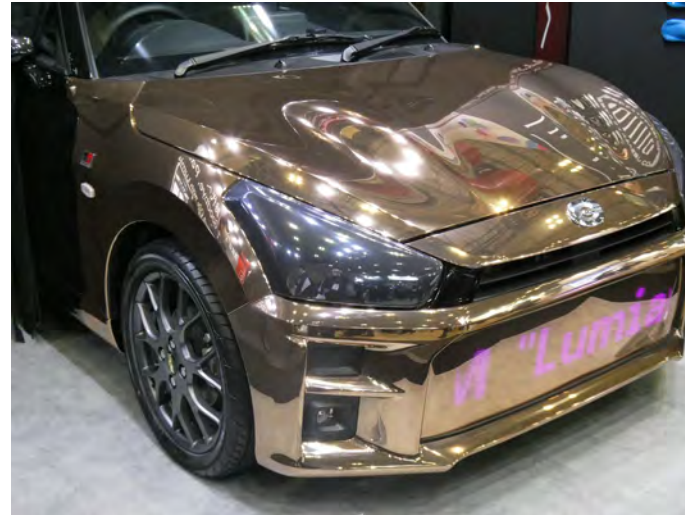
布施真空のOMD成形品例 光透過も盛り込まれている
