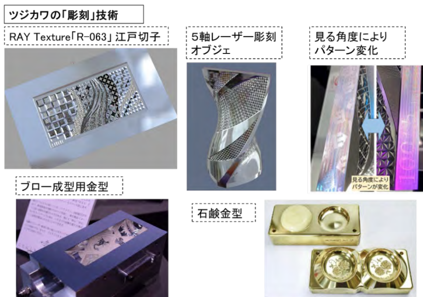
図 3 1 彫刻技術による表面精密加工金型
