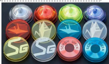
図 2 9 金型表面精密加工の微細転写成形品例－1
