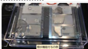
図 2 9 金型表面精密加工の微細転写成形品例－1
