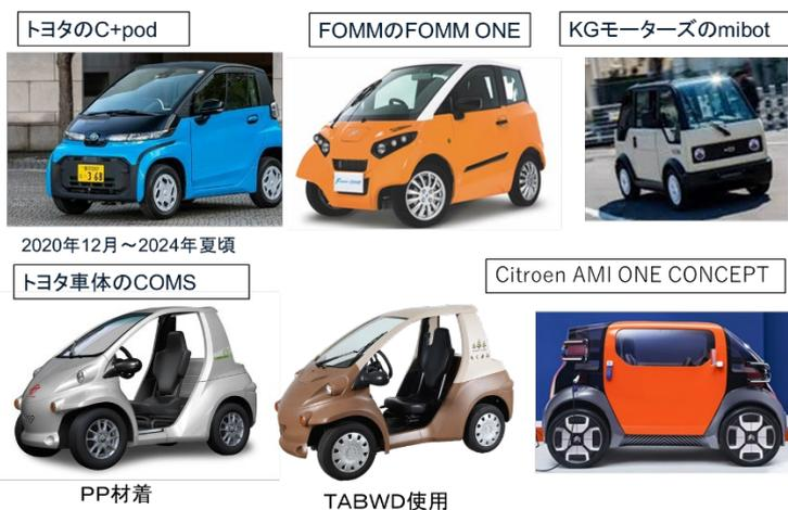
図 4 3 外板が材着プラスチックの小型EV車
