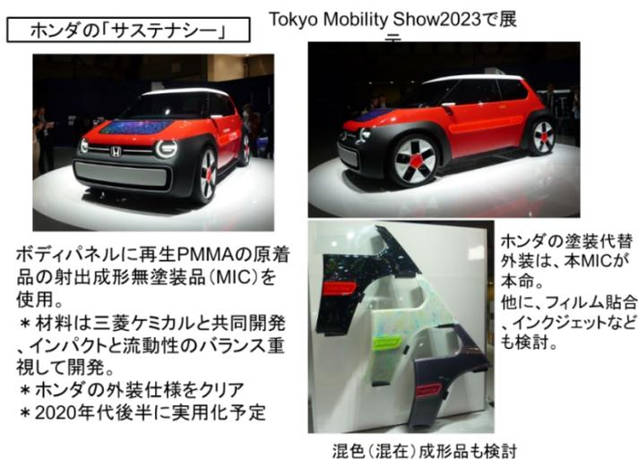
図3 5 モールドインカラーによる塗装代替自動車外装試作例（日本）ー 1
