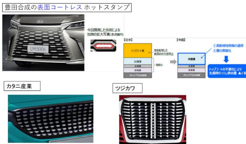
図49 ホットスタンプによる塗装代替自動車外装等検討、採用例
