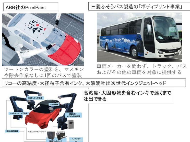
図48 インクジェットによる塗装代替自動車外装等検討、採用例
