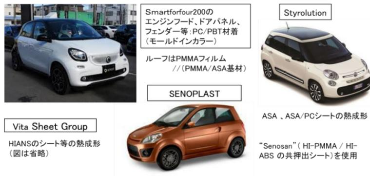
図3 1 モールドインカラーによる塗装代替自動車外装採用例 (欧州)
