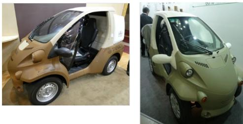
図 3 9 植物繊維複合材料の自動車外装などへの採用例
