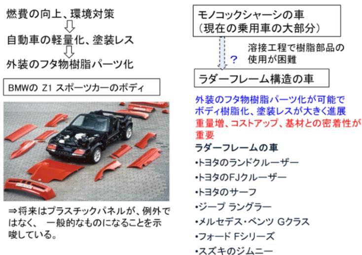
図 5 0 ボディ樹脂化、塗装レスの流れ
