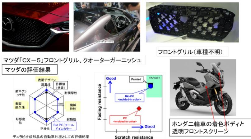
図3 3 モールドインカラーによる塗装代替自動車外装試作、採用例 (日本) - 1
