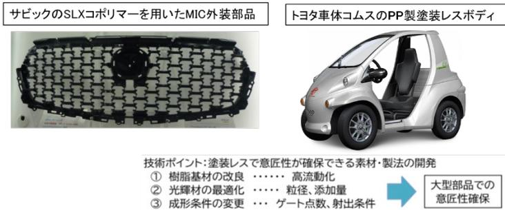
図3 4 モールドインカラーによる塗装代替自動車外板採用例（日本）ー 2
