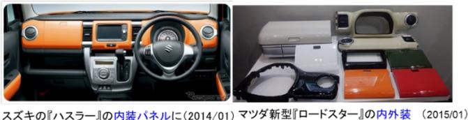
図3 2 モールドインカラーによる自動車内装採用例 (日本) - 1
